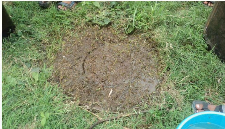
Gambar 4.2 Kondisi Tanah Setelah Pengukuran Laju Infiltrasi
