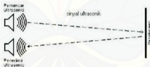
Gambar 2.6 Diagram Sinyal Ultrasonik
