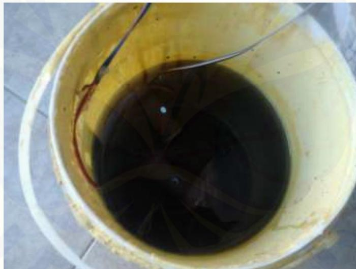
Gambar 4.7 Uji Air Menggunakan Tinta Hitam 1ml Dengan Sensor Kejernihan
