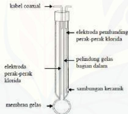
Gambar 2.13 Elektroda pH kombinasi
