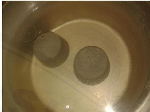
Gambar 13. Benda uji hasil pengujian vicat
