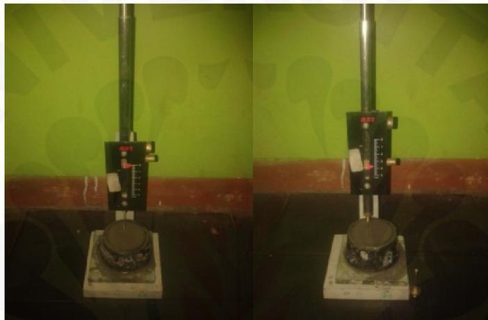
**Gambar 7.** Pengujian *Setting Time*
