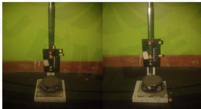
**Gambar 4 .** Pengujian *Setting Time*
