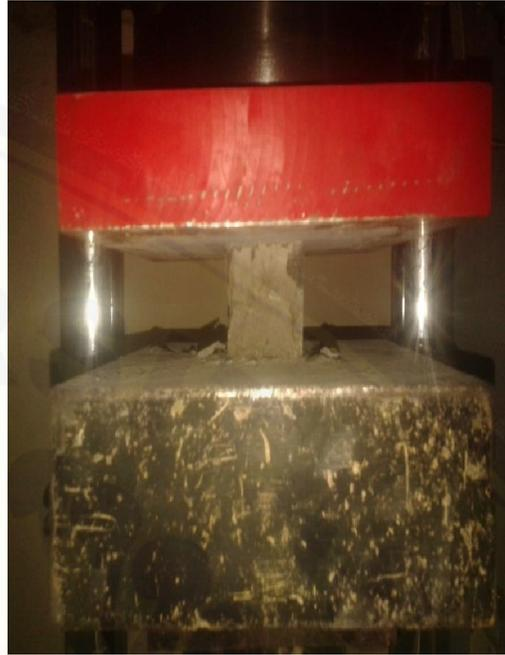
Gambar 9. Benda uji sewaktu uji tekan
