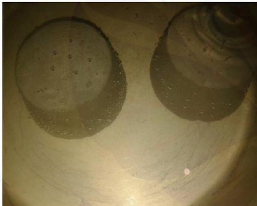
Gambar 12. Benda uji hasil pengujian vicat
