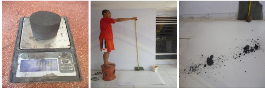
(h) Pengujian Drop Test menimbang briket sebelum dijatuhkan kemudian diuji dengan ketinggian 180 cm
