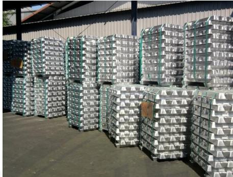
Gambar 1. Bahan baku ingot berbentuk padat dan mengandung bahan kimia Aluminium
