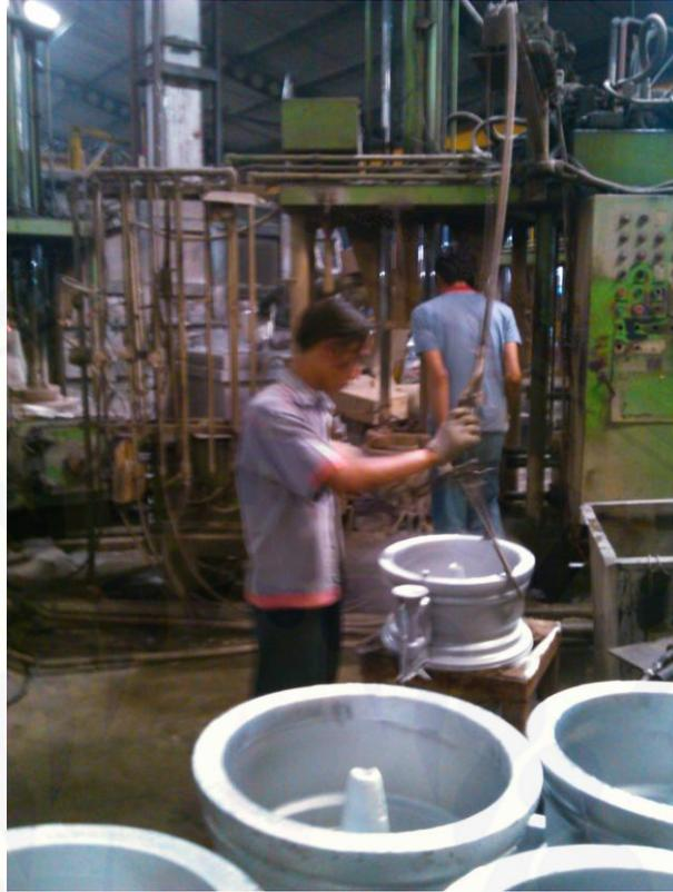
Gambar 4.7 Proses Pemindahan *Velg* dari Matras atau Cetakan Menuju Meja Pemotongan Pertama
