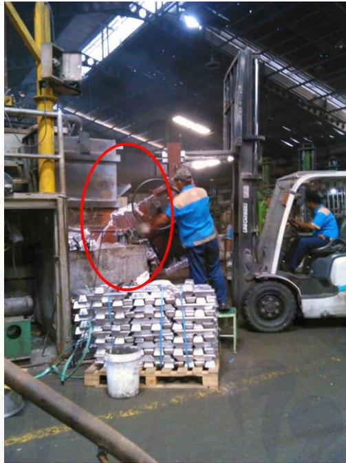
Gambar 4.3 Penuangan Cairan Ingot yang Telah melalui Proses *Re-Melting*
