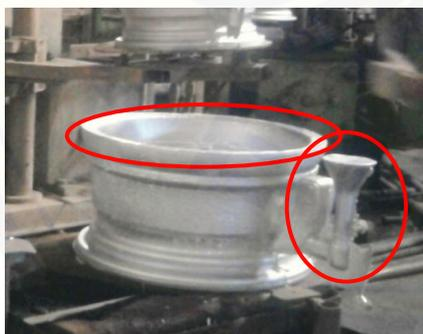
Gambar 5. Bagian velg yang akan dipotong secara manual maupun dengan mesin
