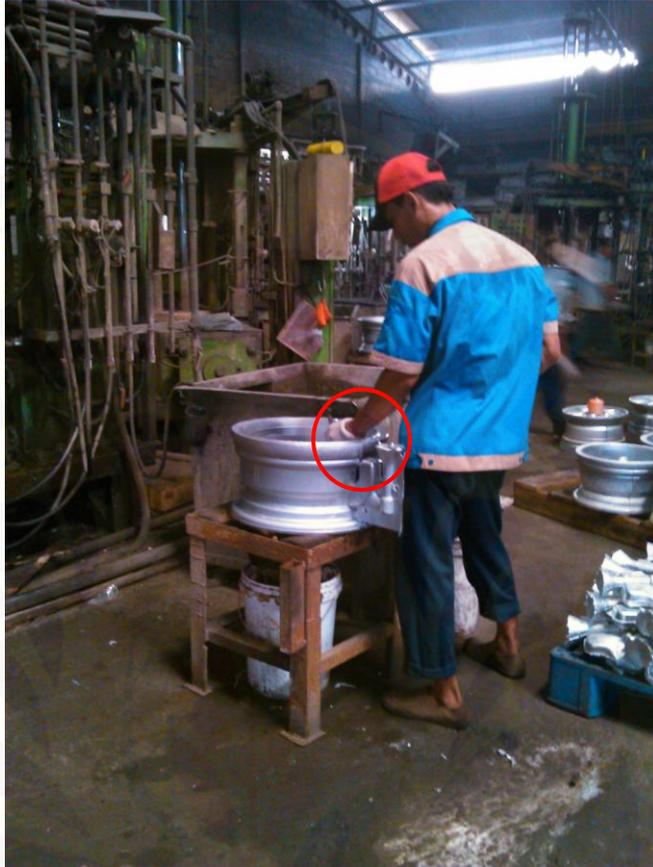
Gambar 4.8 Proses Memotong Bagian *Velg* secara Manual
