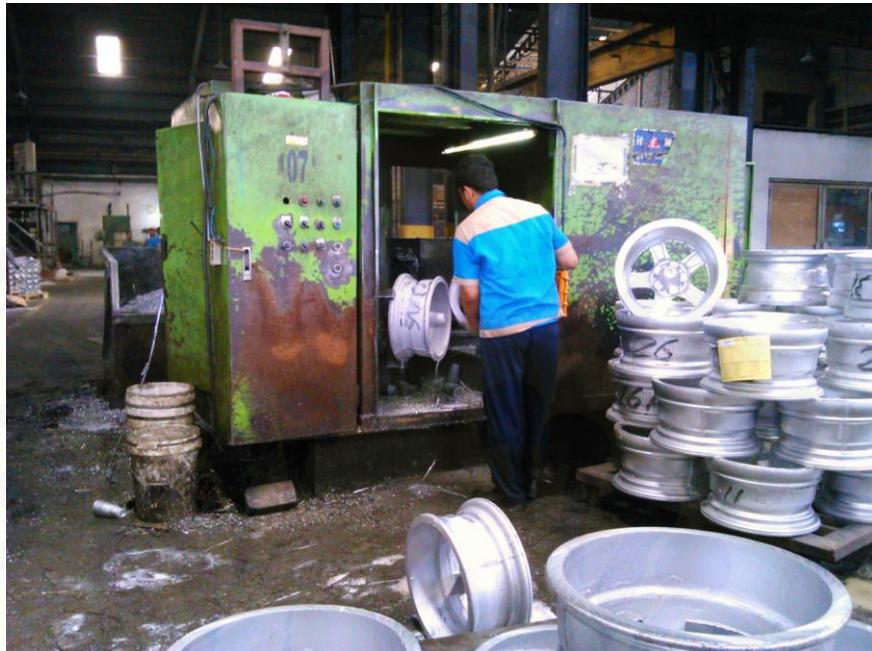
Gambar 4.9 Proses Memotong *Velg* dengan Mesin *Cutting*
