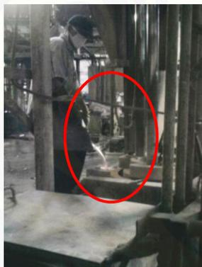
Gambar 3. Proses menuang cairan ingot ke matras atau cetakan yang berisiko terjadinya kejadian ketumpahan
