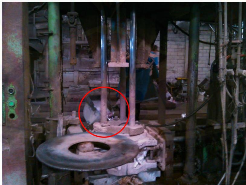
Gambar 4.5 Proses Menuangkan Cairan Ingot ke dalam Matras secara Manual
