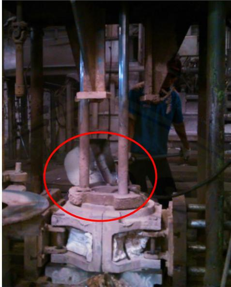
Gambar 4.22 Gayung yang Digunakan untuk Menuang Cairan Ingot secara Manual
