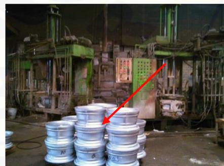
Gambar 6. Kondisi velg setelah proses pencetakan
