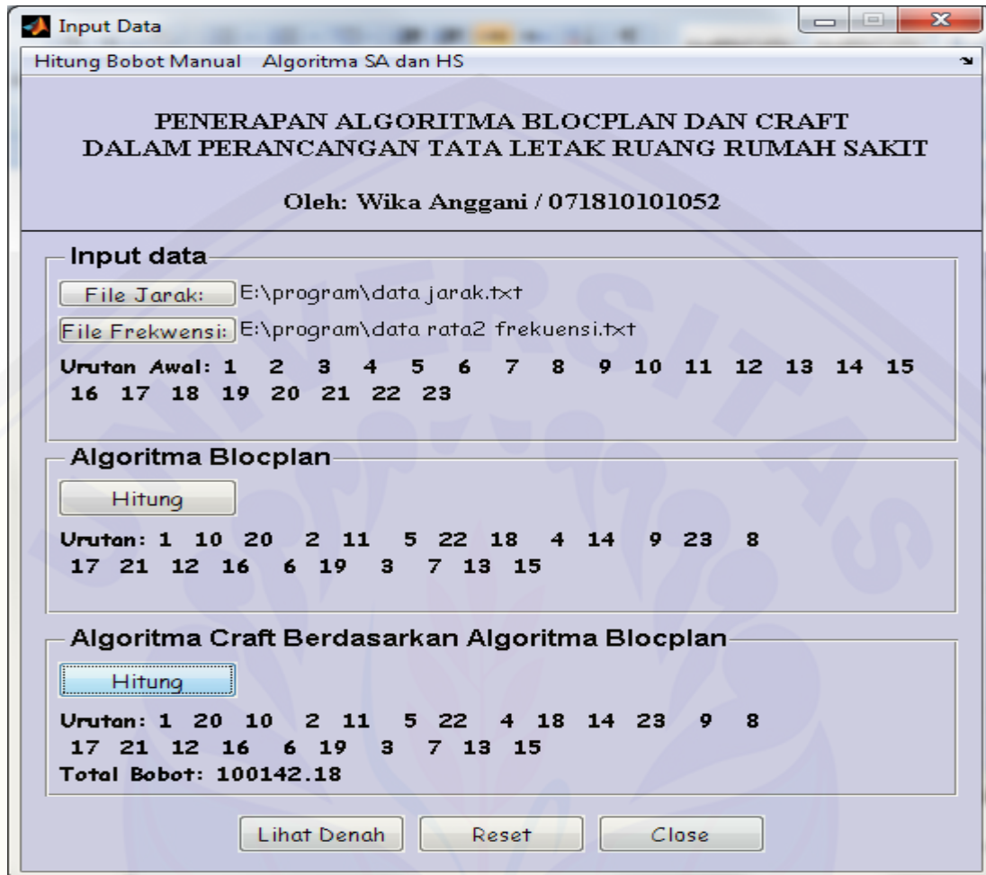
Gambar 4.5 Tampilan program penerapan algoritma Craft pada tata letak ruang berdasarkan Algoritma Blocplan
