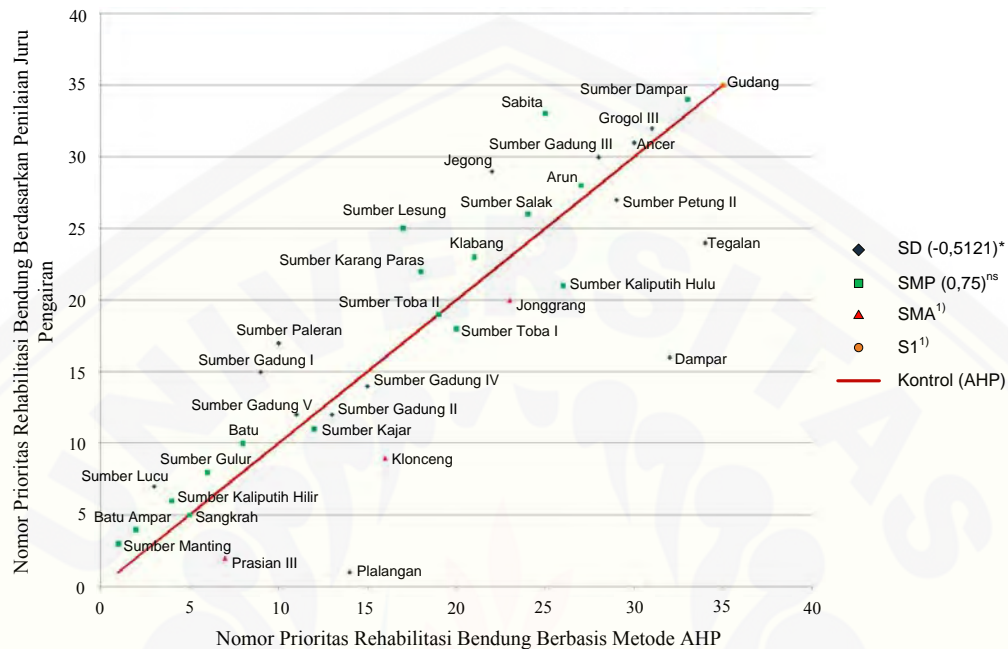
Gambar 4.7 Hasil Penetapan Nomor Prioritas Rehabilitasi Bendung Berdasarkan Tingkat Pendidikan Juru Pengairan
