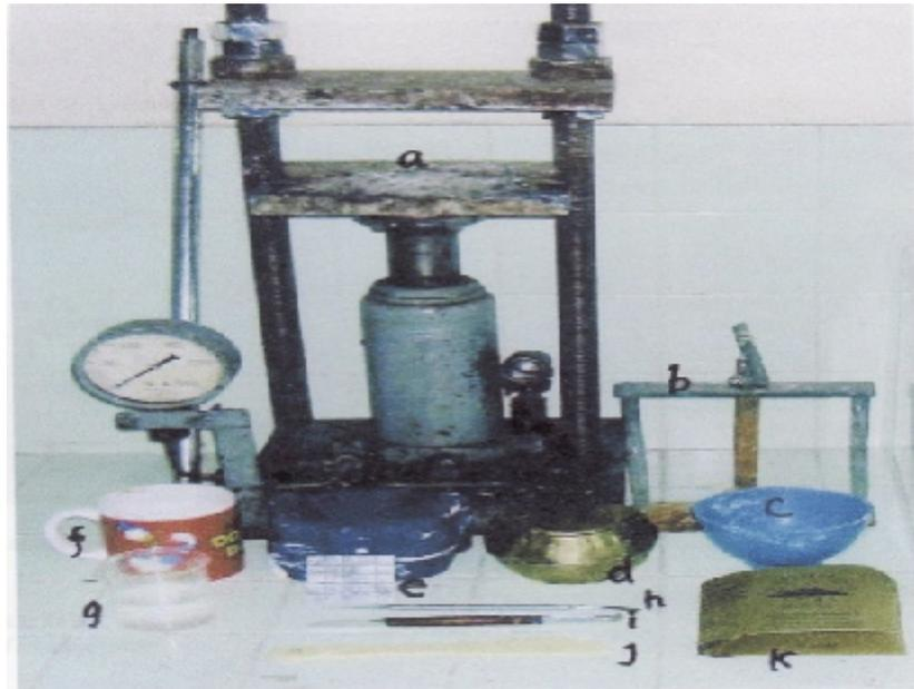
Gambar 12. Alat-alat yang digunakan untuk pembuatan plat resin akrilik: (a) *bench press* ; (b) *beugel* ; (c) mangkuk karet ; (d) kuvet ; (e) cetakan malam ; (f) *mixing jar* ; (g) *beaker glass*
