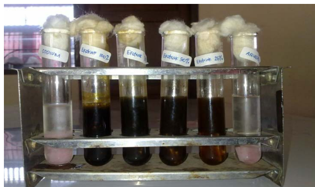
Gambar 13. Plat resin akrilik direndam dalam berbagai konsentrasi ekstrak limbah kulit buah kakao, sodium hipoklorit dan aquades steril selama 6 jam
