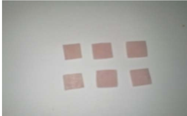
Gambar 3.1. Plat resin akrilik berukuran (10x10x1) mm
