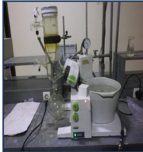
d. Proses evaporasi dengan rotary evaporator
