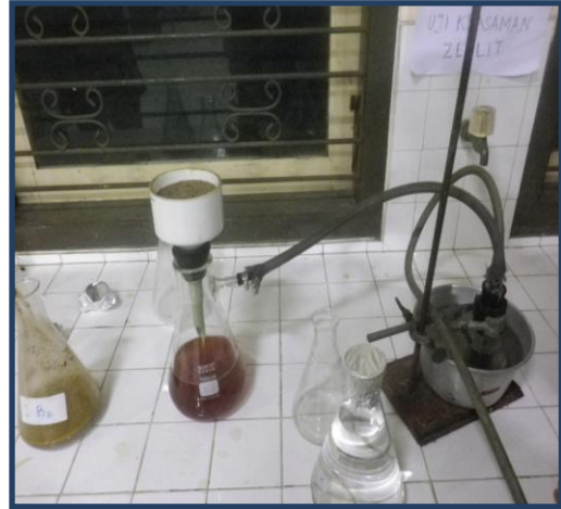
b. Pengekstrakan dengan etanol 95%
