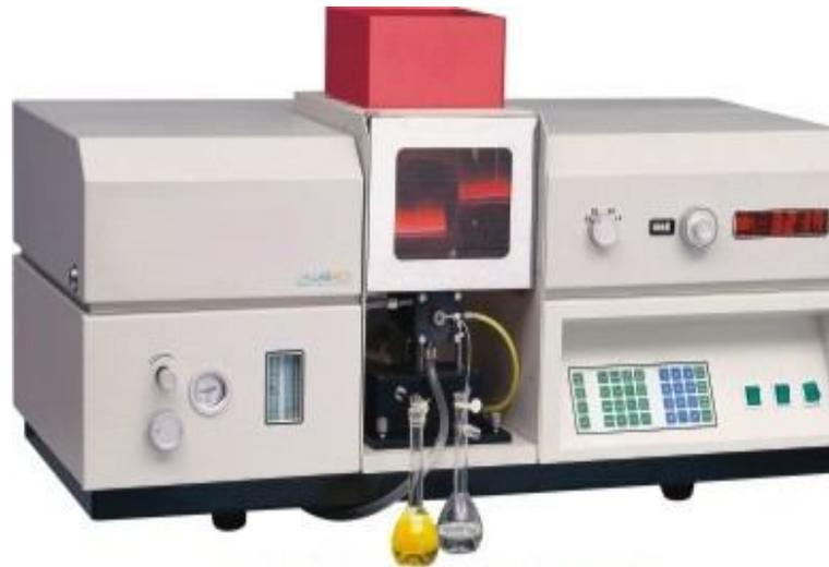
Gambar 2.5 Spektrofotometer Serapan Atom (Anonim, 2011a)
