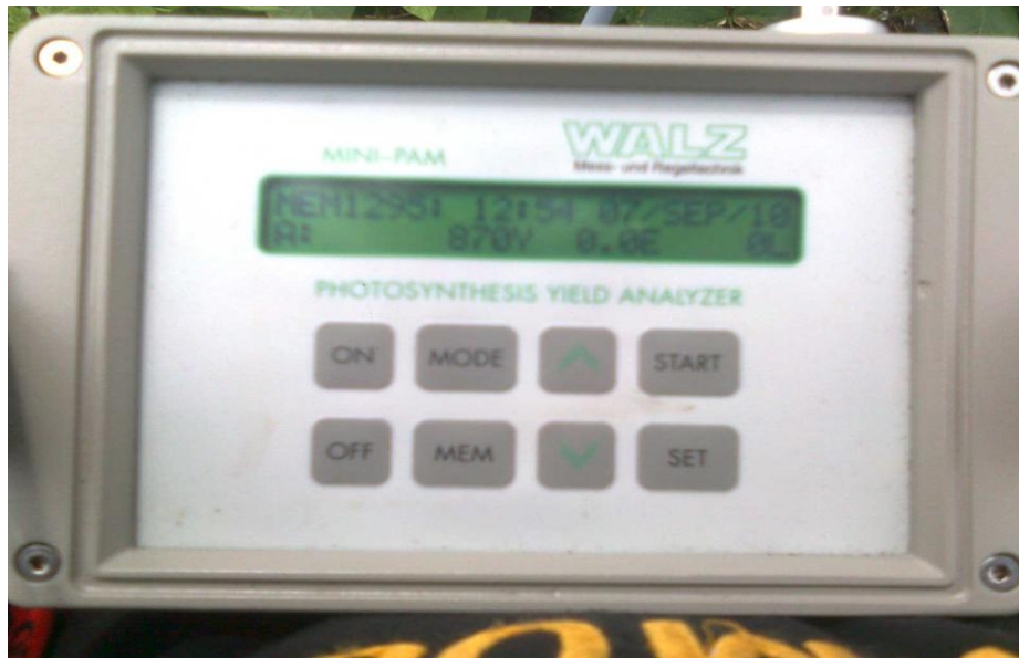
Gambar 13. Mini-PAM Alat untuk mengukur Laju Fotosintesis Tanaman
