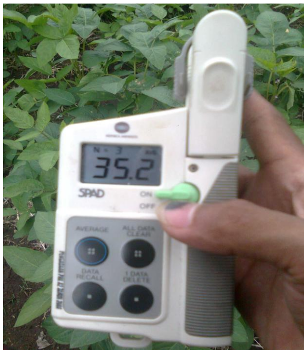
Gambar 12. Chlorophyll meter SPAD-502 Alat untuk mengukur klorofil Tanaman
