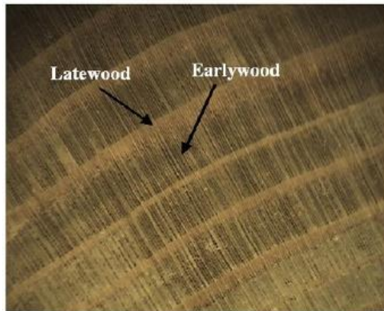
Gambar 2.1 Struktur anatomi kayu lunak (Sumber: Viney, 2010)
