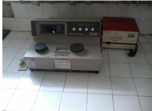
Gambar 12. Spektrofotometer ( alat untuk mengukur kadar sianida)
