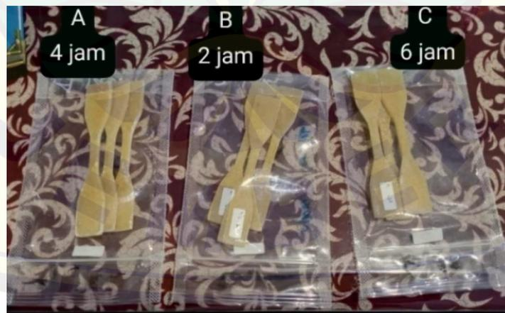
Gambar 4. 2 Spesimen Komposit Serat Ampas Tebu PRG-Epoxy
