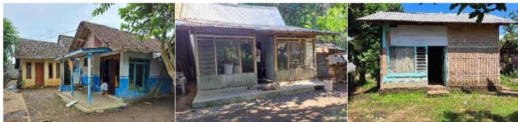
Gambar 4. 5 Bangunan Rumah (a) Dinding Tembok dan Lantai Setengah Keramik, (b) Dinding Triplek dan Lantai Tegel/ubin, dan (c) Dinding Sesek/Gedek dan lantai Tanah
