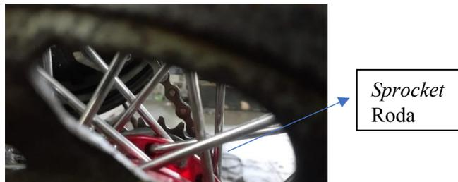
Gambar 4.2 Sprocket yang digerakkan (Roda)
