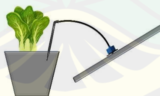
Gambar 3.4 Saluran output irigasi tetes
