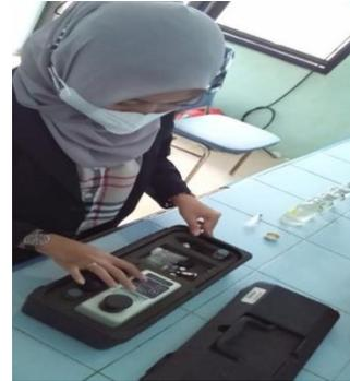
(c) Pengukuran Kekeruhan dengan Turbidimeter
