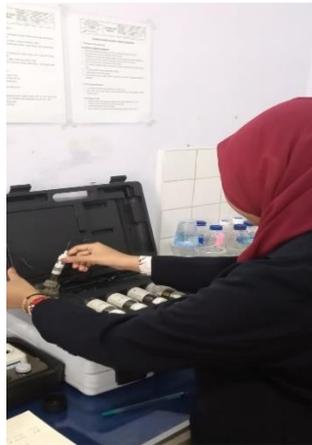
(d) Pengukuran pH menggunakan pH meter
