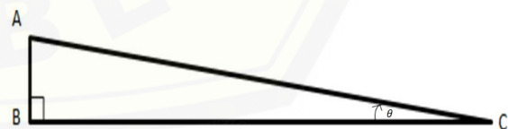
Gambar 3. Segitiga Pythagoras untuk menentukan sudut kemiringan jalan
