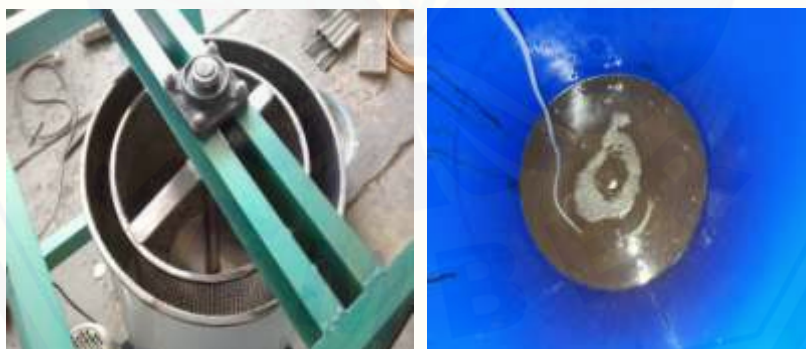
Gambar 9. Alat sentrifuse pengestrak kompos dan fermentor sederhana
