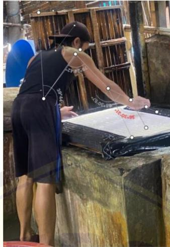
Gambar 4.2 Perataan Lembar Kain pada masing-masing cetakan
