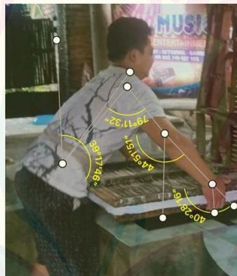
Gambar 4.5 Aktivitas Pembalikan Tahu Pada Pencetakan I
