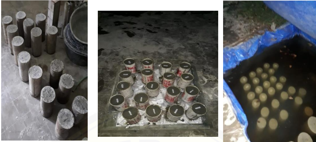
Lampiran B.7 Foto Benda Uji yang Sudah Dilepas Kemudian Direndam dalam Kolam Air
