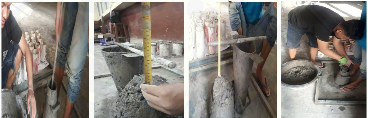
Lampiran B.6 Foto Pengujian Nilai Slump
