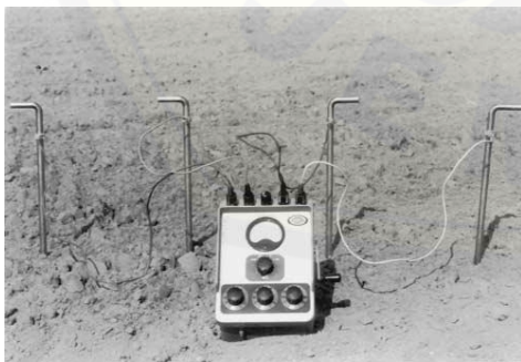
Gambar 2. Peralatan pengukuran nilai EC tanah secara langsung dengan metode Wenner array (Rhoades & Oster, 1986)
