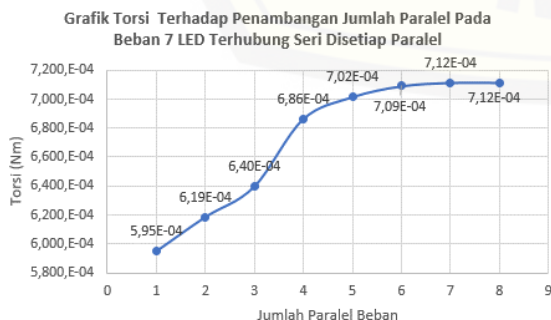
Gambar 25. Grafik Torsi Terhadap Penambahan Jumlah Paralel Pada Beban 7 LED Terhubung Seri Disetiap Paralel
