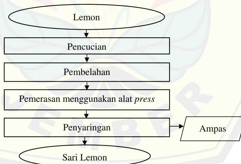
Gambar 3.3 Diagram alir pembuatan sari lemon
