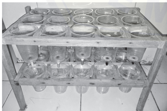
Gambar 2. Seperangkat alat adsorpsi air limbah kopi
