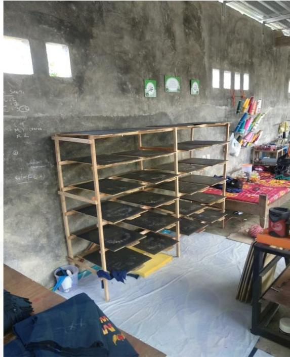
Gambar 7 Rak yang digunakan untuk mengeringkan cat setelah proses penyablonan
