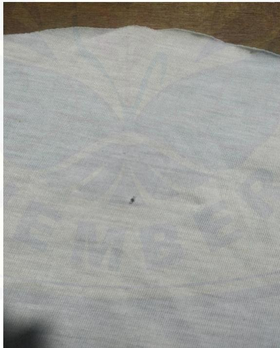
Gambar 14 Terjadinya kecacatan kain dari perusahaan kain setelah dilakukan proses pemotongan ukuran
