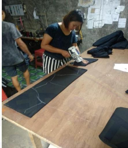
Gambar 4.5 Proses Pemotongan Kain
