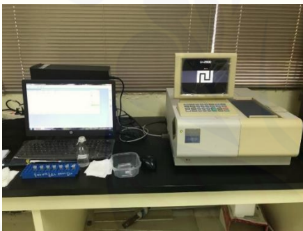
Gambar 1.3 Mengukur absorbansi larutan klorofil dengan menggunakan spektrofotometer
