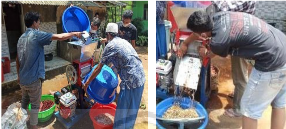
Gambar 3. Proses pulping buah kopi dengan mesin pulper
