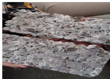
Gambar 13. Benda Uji Beton Berpori Setelah Pengujian Kuat Tarik Belah
