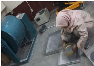
Gambar 5. Pengujian Keausan Agregat Kasar
