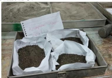
Gambar 2. Pengujian Kelembaban Agregat Halus
