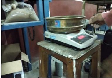
Gambar 3. Pengujian Analisa Saringan Agregat Halus
