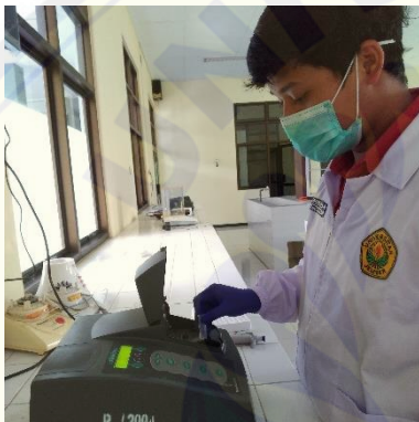
Pengukuran Supernatan menggunakan spektrofotometer dengan panjang gelombang 535 nm
