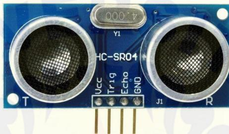
**Gambar 2.6** Bentuk fisik sensor ultrasonik HC-SR04(Sumber : [digi-bytes.com](http://digi-bytes.com))
