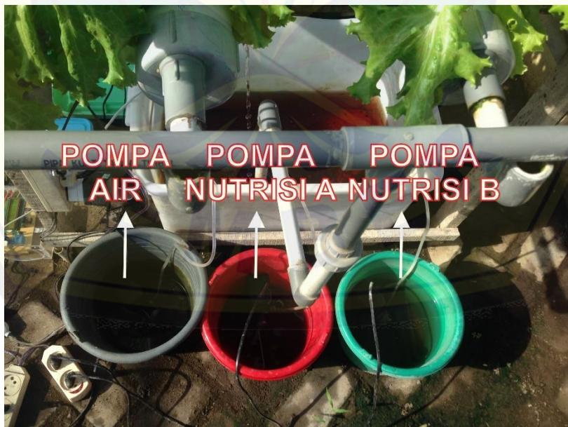
Gambar 3.12 Posisi Pompa-pompa
