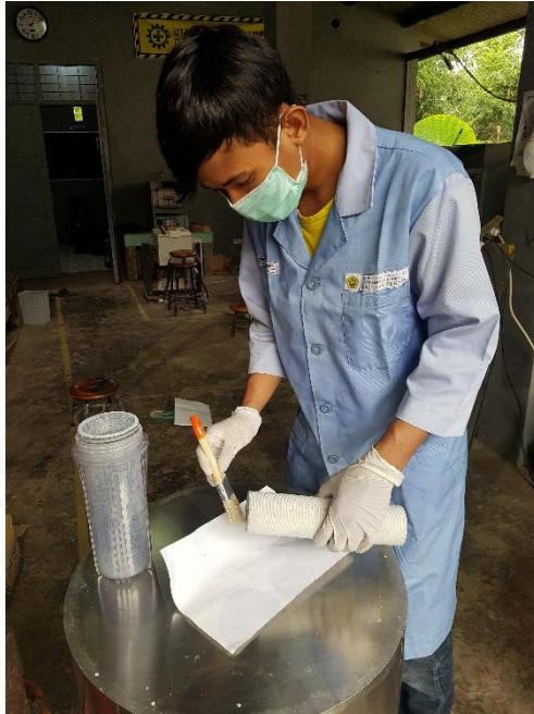
Gambar D.9 Proses Pengumpulan Serbuk Zinc Oxide dari Filter
