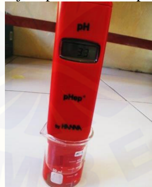
Pengukuran pH biji kopi selama proses fermentasi
