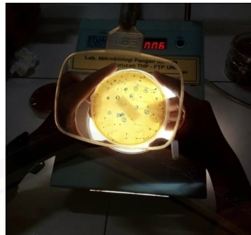
Perhitungan mikroba dengan menggunakan colony counter
