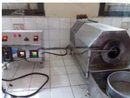
Setting Suhu dan Lama Waktu Pada Alat Penyangrai serta Proses Penyangraian
