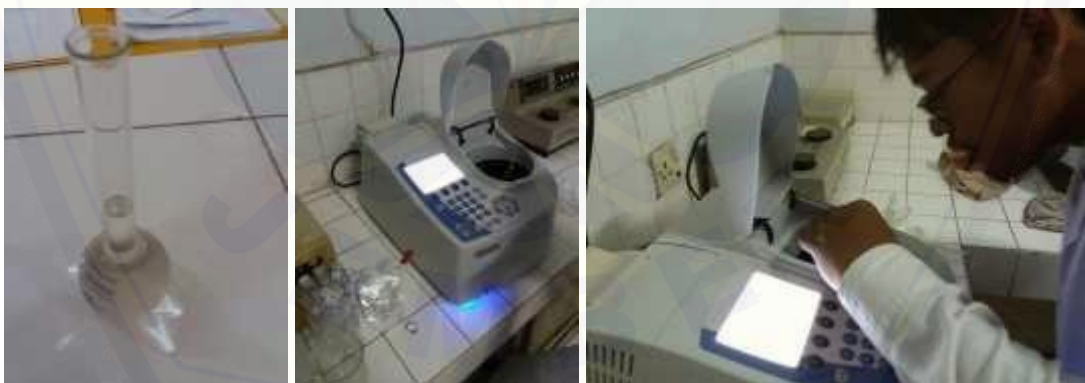
Pembuatan Kurva Standar Kafein dan Pembacaan Absorbansi Sampel
