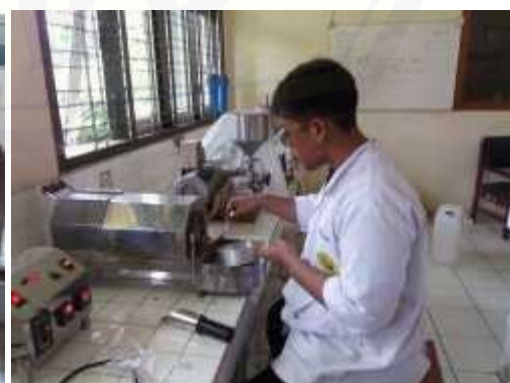
Setting Suhu dan Lama Waktu Pada Alat Penyangrai serta Proses Penyangraian
