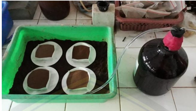
Gambar 4. Proses penjenuhan contoh tanah terusik
