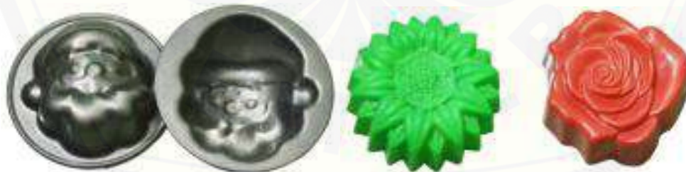
Gambar 2.4 Cetakan Belerang dari Logam dan Plastik
