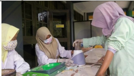
Gambar 7. Penimbangan berat kering cacing tanah
