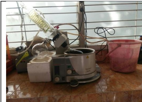
Gambar 13. Menguapkan dengan rotary evaporatory
