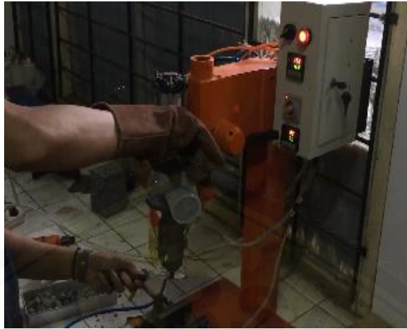
Gambar 16. Masukkan bahan ke barrel
