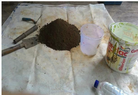
c. Pencampuran pasir, bentonit, dan air
