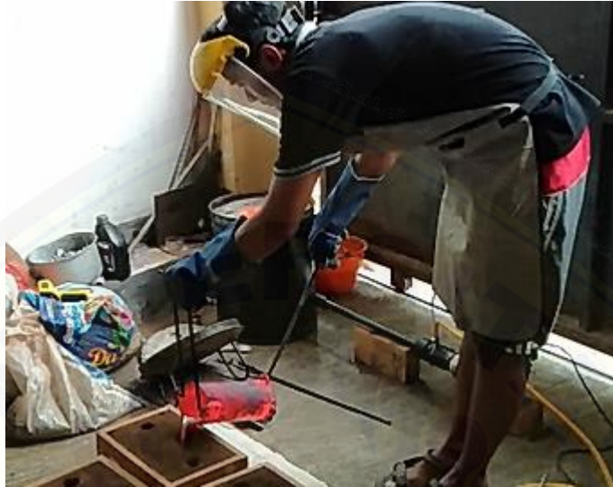
h. Proses pengambilan produk cor dari cetakan pasir
