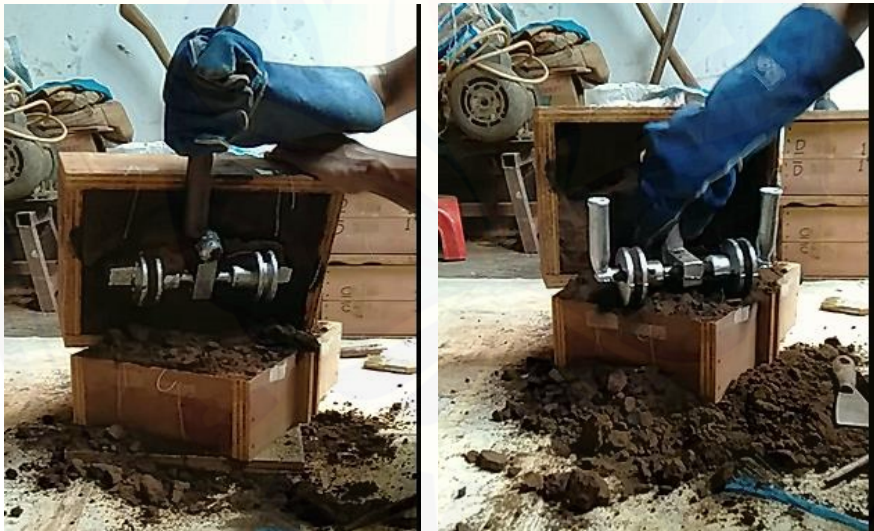
h. Proses pengambilan produk cor dari cetakan pasir
