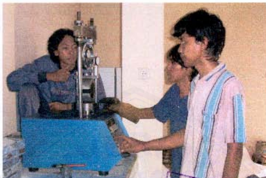
Foto 7. Proses Pengujian Marshall
