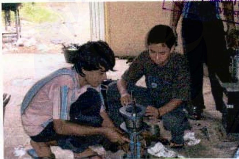
Foto 4. Proses Mengeluarkan Benda Uji Dari Silinder Cetakan Pematik
