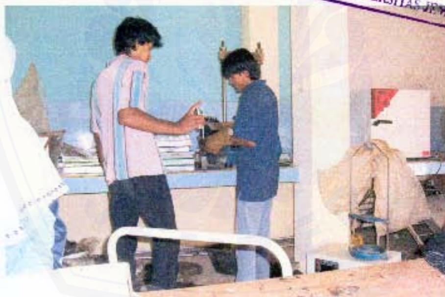
Foto 8. Proses Pengambilan Benda Uji Dari Alat Marshall
