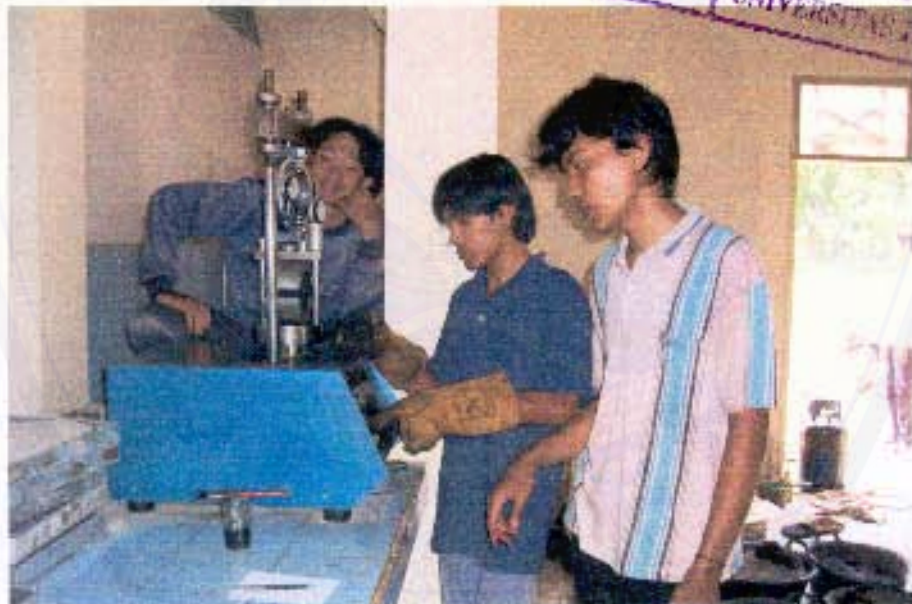
Foto 6. Proses Pengujian Marshall
