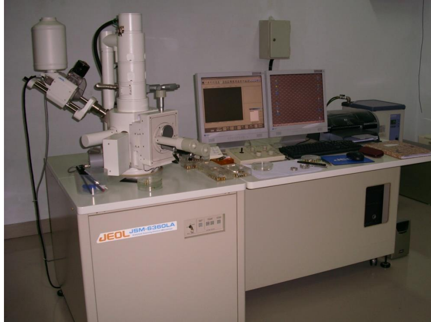
Gambar 7. Sistem Peralatan SEM dan EDS merk Jeol JSM 6360LA (Sumber Lab. Geologi , Pusat Survei Geologi, Bandung)
