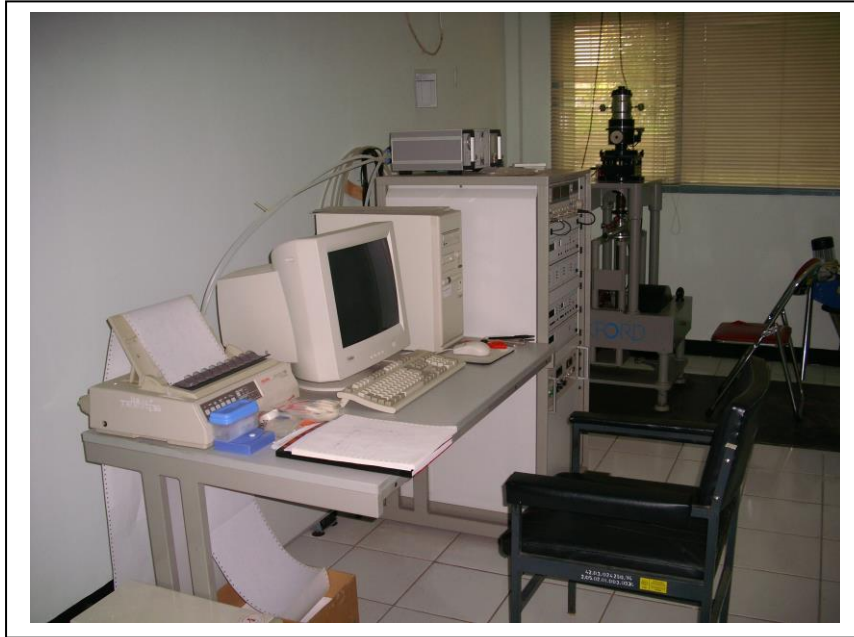
Gambar 4. Alat vibrating sample magnetometer (VSM) ( Oxford ) digunakan untuk mengkarakterisasi sifat magnetik bahan (sumber: PTBIN BATAN, PUSPITEK, Serpong)
