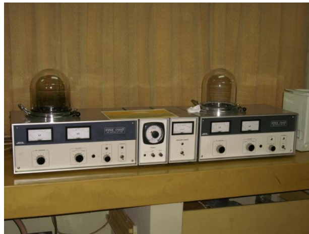
Gambar 3. Alat evaporator digunakan untuk mengcoating bahan
