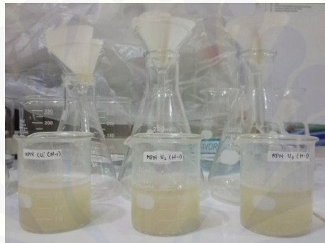
Pengukuran TSS secara gravimetri
