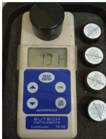
Pengukuran kekeruhan menggunakan Turbidity meter
