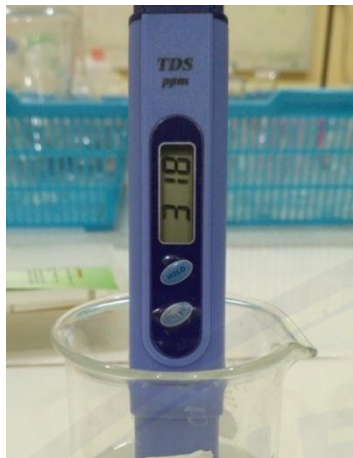
Pengukuran TDS menggunakan TDS meter
