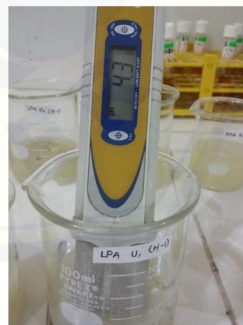
Pengukuran pH menggunakan pH meter
