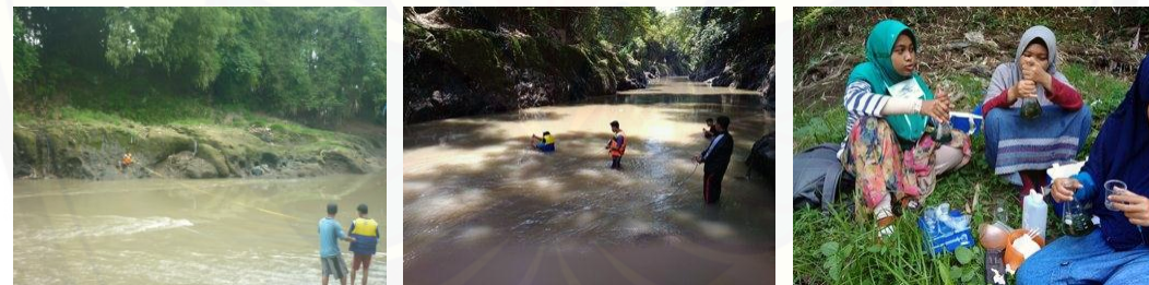
Gambar 2. Pengambilan data dan pengujian sampel di lapang (a) Pengukuran lebar sungai; (b) Pengukuran kecepatan aliran sungai; (c) Pengujian DO lapang
