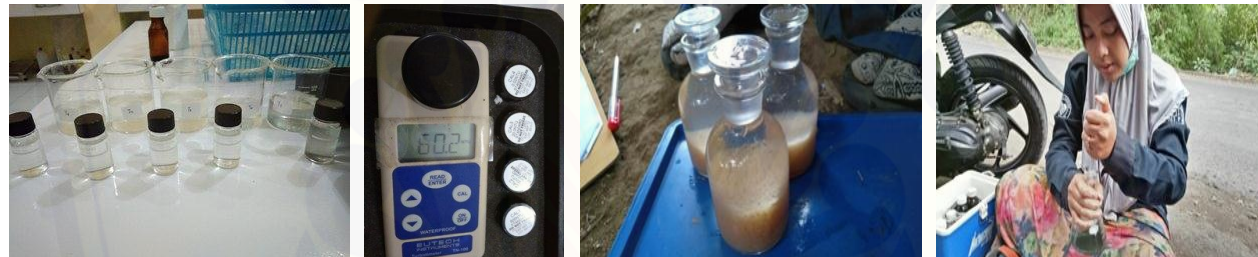
Gambar 4. (a) dan (b) Uji parameter kekeruhan; (c) dan (d) Uji parameter DO (lapang) metode Winkler
