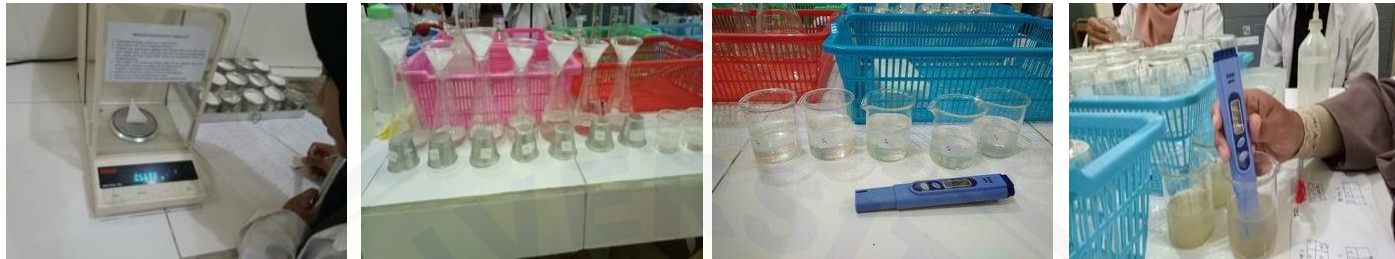
Gambar 3. (a) dan (b) Uji parameter TSS; (c) dan (d) Uji parameter TDS
