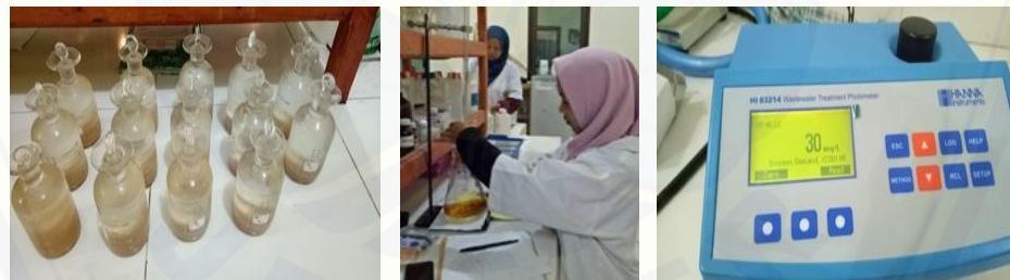
Gambar 5. (a) Sampel uji parameter DO metode Winkler; (b) Pengujian DO laboratorium tahap titrasi; (c) Uji parameter COD
