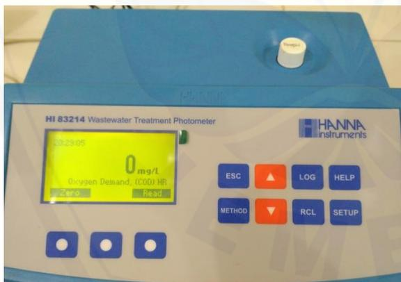
Pengukuran COD dengan Spektrofotometer
