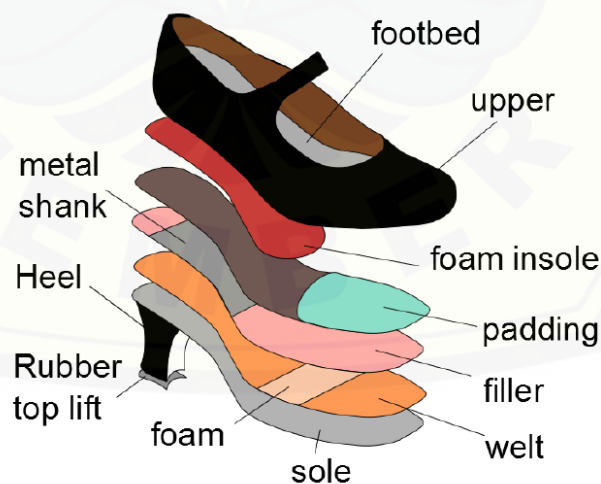
Gambar 2.5 Struktur sepatu hak tinggi (Sumber: Melvin, 2014)
