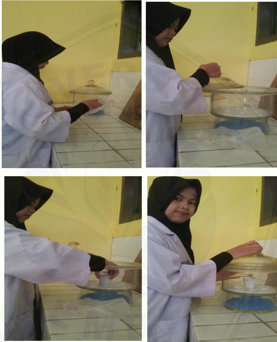
Gambar 3.2 Pendinginan biji kopi kedalam desikator setelah di keringkan menggunakan oven dan di keringkan dengan paparan sinar matahari
