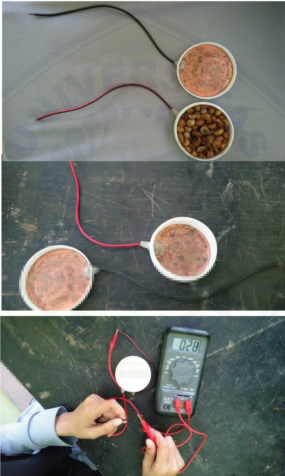
Gambar 3.3 pengukuran biji kopi menggunakan rancangan bahan ajar kapasitansi kapasitor dan alat kapasitansimeter
