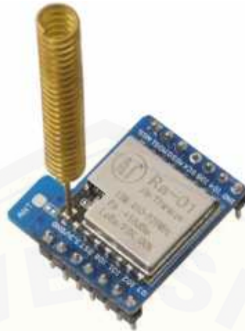
Gambar 2.6. Bentuk fisik LORA SX1278 ( https://www.smart-prototyping.com )
