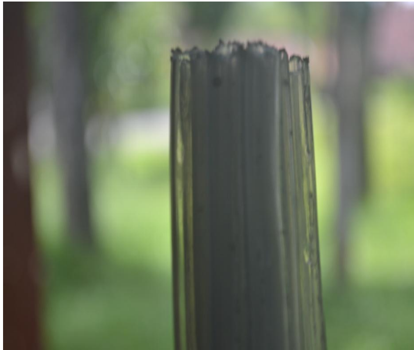
Gambar L3.9 tube bundle ukuran 0,25 inchi
