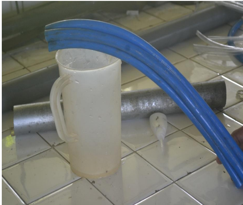
Gambar L3.5 tube bundle ukuran 0,5 inchi
