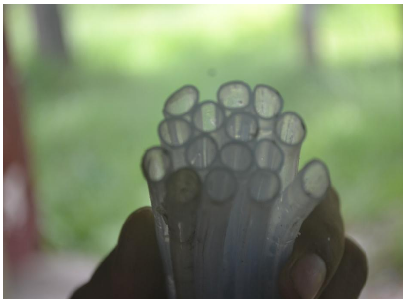
Gambar L3.10 tube bundle ukuran 0,25 inchi tampak depan
